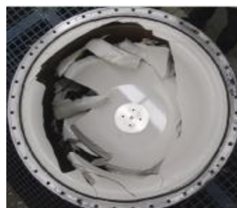
图 12 1 100 kV 盆式绝缘子破坏形态
